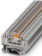
Trennklemme, Nennspannung: 400 V, Nennstrom: 26 A, Anschlussart: Schraubanschluss, Bemessungsquerschnitt: 4 mm<sup>2</sup>, Querschnitt: 0,2 mm<sup>2</sup> - 4 mm<sup>2</sup>, Montageart: NS 35/7,5, NS 35/15, NS 32, Farbe: grau
