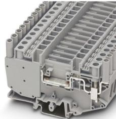
Durchgangsklemme, Nennspannung: 500 V, Nennstrom: 41 A, Anzahl der Anschlüsse: 2, Anschlussart: Schraubanschluss, Bemessungsquerschnitt: 6 mm<sup>2</sup>, 1. Etage, Querschnitt: 0,5 mm<sup>2</sup> - 10 mm<sup>2</sup>, Montageart: NS 35/7,5, NS 35/15, NS 32, Farbe: grau
