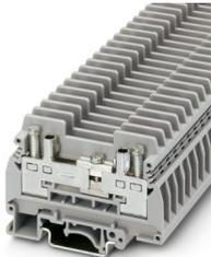
Messwandler-Trennklemme, mit zwei Prüfbuchsen für 4-mm-Prüfstecker oder zur Aufnahme von Schalt- oder Schraubbrücken, Nennspannung: 400 V, Nennstrom: 41 A, Anschlussart: Schraubanschluss, 1. Etage, Bemessungsquerschnitt: 6 mm<sup>2</sup>, Querschnitt: 0,5 mm<sup>2</sup> - 10 mm<sup>2</sup>, Montageart: NS 35/7,5, NS 35/15, NS 32, Farbe: grau
