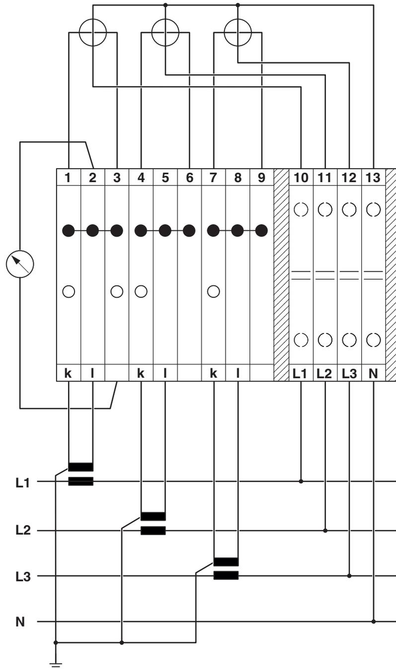
Zählerprüfsatz (Wirkstrom) aufgebaut mit UGSK und UR TK-BEN
