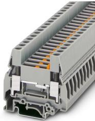
Messwandler-Trennklemme, Nennspannung: 500 V, Nennstrom: 57 A, Anschlussart: Schraubanschluss, Bemessungsquerschnitt: 10 mm<sup>2</sup>, Querschnitt: 0,5 mm<sup>2</sup> - 16 mm<sup>2</sup>, Montageart: NS 35/7,5, NS 35/15, NS 32, Farbe: grau
