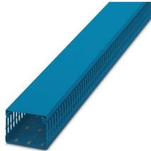
Canaleta de cabeamento para a instalação de montagem em quadros de comando, azul, sem halogênio, composta de peça superior e inferior, largura: 80 mm, altura: 60 mm, comprimento: 2000 mm
