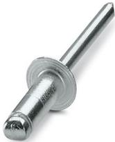
Rebites de repuxo, Ø 4,8 mm, comprimento da manga: 16 mm, manga de alumínio, punção em aço galvanizado, cabeça plana, variante padrão conforme DIN 7337 A
