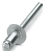
Rebites de repuxo, Ø 4,0 mm, comprimento da manga: 8 mm, manga de alumínio, punção em aço galvanizado, cabeça plana, variante padrão conforme DIN 7337 A
