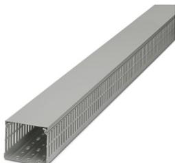
Canaleta de cabeamento para a instalação de montagem em quadros de comando, cinza, composta de peça superior e inferior, largura: 80 mm, altura: 25 mm, comprimento: 2000 mm
