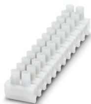
Régua de bornes Europa de poliamida, transparente, para conectar condutores rígidos e flexíveis com terminal tubular com bitola de 10 a 25 mm<sup>2</sup>
