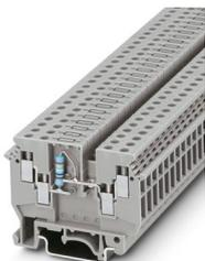
Borne de passagem, com parafusos para conector de teste para o alojamento de conectores de teste, tensão nominal: 630 V, corrente nominal: 32 A, quantidade de conexões: 4, tipo de conexão: Conexão a parafuso, Bitola: 4 mm<sup>2</sup>, 1. nível, perfil de conexão: 0,2 mm<sup>2</sup> - 6 mm<sup>2</sup>, tipo de montagem: NS 35/7,5, NS 35/15, NS 32, cor: cinza
