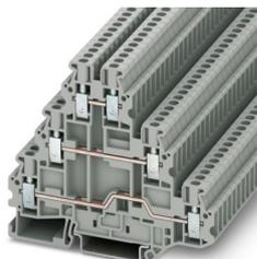
Borne de vários andares, tensão nominal: 500 V, corrente nominal: 19 A, tipo de conexão: Conexão a parafuso, Bitola: 2,5 mm<sup>2</sup>, perfil de conexão: 0,14 mm<sup>2</sup> - 4 mm<sup>2</sup>, tipo de montagem: NS 35/7,5, NS 35/15, cor: cinza
