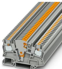
Borne de seccionamento de teste, tensão nominal: 500 V, corrente nominal: 24 A, quantidade de conexões: 2, tipo de conexão: Conexão Push-in, Bitola: 4 mm<sup>2</sup>, 1. nível, perfil de conexão: 0,2 mm<sup>2</sup> - 6 mm<sup>2</sup>, tipo de montagem: NS 35/7,5, NS 35/15, cor: cinza
