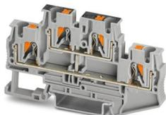
Borne de dois níveis, com conector de potencial, tensão nominal: 500 V, corrente nominal: 30 A, tipo de conexão: Conexão Push-in, 1. e 2o. nível, Bitola: 4 mm<sup>2</sup>, perfil de conexão: 0,2 mm<sup>2</sup> - 6 mm<sup>2</sup>, tipo de montagem: NS 35/7,5, NS 35/15, cor: cinza
