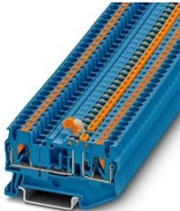
Borne seccionável, tensão nominal: 400 V, corrente nominal: 20 A, tipo de conexão: Conexão Push-in, Bitola: 2,5 mm<sup>2</sup>, bitola: 0,14 mm<sup>2</sup> - 4 mm<sup>2</sup>, montagem: NS 35/7,5, NS 35/15, cor: azul
