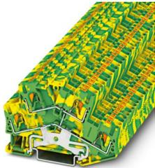
Borne terra duplo, quantidade de conexões: 4, tipo de conexão: Conexão Push-in, perfil de conexão: 0,14 mm<sup>2</sup> - 4 mm<sup>2</sup>, tipo de montagem: NS 35/7,5, NS 35/15, cor: verde-amarelo
