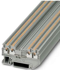
Borne de passagem, tensão nominal: 500 V, corrente nominal: 17,5 A, quantidade de conexões: 4, tipo de conexão: Conexão Push-in, Bitola: 1,5 mm<sup>2</sup>, perfil de conexão: 0,14 mm<sup>2</sup> - 1,5 mm<sup>2</sup>, tipo de montagem: NS 35/7,5, NS 35/15, cor: cinza
