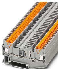
Borne de seccionamento, Corrente e tensão são definidos pelos conectores plugáveis aplicados., tensão nominal: 400 V, corrente nominal: 17,5 A, 1. nível, tipo de conexão: Conexão rápida, Bitola: 1,5 mm<sup>2</sup>, bitola: 0,25 mm<sup>2</sup> - 1,5 mm<sup>2</sup>, montagem: NS 35/7,5, NS 35/15, cor: cinza
