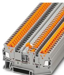
Borne seccionável, tensão nominal: 400 V, corrente nominal: 17,5 A, 1. nível, tipo de conexão: Conexão rápida, Bitola: 1,5 mm<sup>2</sup>, bitola: 0,25 mm<sup>2</sup> - 1,5 mm<sup>2</sup>, montagem: NS 35/7,5, NS 35/15, cor: cinza
