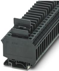
Borne fusível, tipo de fusível: Vidro/cerâmica/..., tipo de fusível: G / 5 x 20 / 5 x 25, tensão nominal: 400 V, corrente nominal: 6,3 A, tipo de conexão: Conexão a parafuso, 1. nível, Bitola: 1 mm<sup>2</sup>, bitola: 0,2 mm<sup>2</sup>- 4 mm<sup>2</sup>, tipo de montagem: NS 35/7,5, NS 35/15, NS 32, cor: preto
