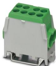
Terminal de derivação do cabo principal, tensão nominal: 400 V, corrente nominal: 101 A, quantidade de conexões: 4, número de polos: 1, tipo de conexão: Conexão a parafuso, Bitola: 25 mm<sup>2</sup>, 1. nível, perfil de conexão: 1,5 mm<sup>2</sup> - 25 mm<sup>2</sup>, Conexão a parafuso, 2. nível, perfil de conexão: 1,5 mm<sup>2</sup> - 16 mm<sup>2</sup>, tipo de montagem: NS 35/7,5, NS 35/15, cor: verde
