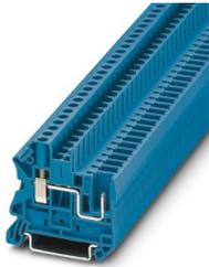
Borne de passagem, tensão nominal: 800 V, corrente nominal: 32 A, quantidade de conexões: 2, tipo de conexão: Conexão a parafuso / plugável, Bitola: 4 mm<sup>2</sup>, perfil de conexão: 0,14 mm<sup>2</sup> - 6 mm<sup>2</sup>, tipo de montagem: NS 35/7,5, NS 35/15, cor: azul
