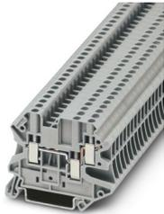
Borne de passagem, tensão nominal: 500 V, corrente nominal: 24 A, quantidade de conexões: 3, tipo de conexão: Conexão a parafuso, Bitola: 2,5 mm<sup>2</sup>, 1. nível, perfil de conexão: 0,14 mm<sup>2</sup> - 4 mm<sup>2</sup>, tipo de montagem: NS 35/7,5, NS 35/15, cor: cinza
