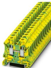
Borne terra, quantidade de conexões: 2, tipo de conexão: Conexão a parafuso, perfil de conexão: 0,2 mm<sup>2</sup> - 10 mm<sup>2</sup>, tipo de montagem: NS 35/7,5, NS 35/15, cor: verde-amarelo
