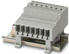
Acoplamento COMBI, tensão nominal: 800 V, corrente nominal: 32 A, quantidade de conexões: 2, tipo de conexão: Conexão à mola, Bitola: 4 mm<sup>2</sup>, perfil de conexão: 0,08 mm<sup>2</sup> - 6 mm<sup>2</sup>, tipo de montagem: NS 35/15, NS 35/7,5, cor: cinza
