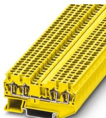
Borne de passagem, tensão nominal: 800 V, corrente nominal: 24 A, quantidade de conexões: 4, tipo de conexão: Conexão à mola, Bitola: 2,5 mm<sup>2</sup>, perfil de conexão: 0,08 mm<sup>2</sup> - 4 mm<sup>2</sup>, tipo de montagem: NS 35/7,5, NS 35/15, cor: amarelo
