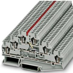
Borne de vários andares, tensão nominal: 500 V, corrente nominal: 20 A, quantidade de conexões: 6, tipo de conexão: Conexão à mola, Bitola: 2,5 mm<sup>2</sup>, 1., 2. e 3o. nível, perfil de conexão: 0,08 mm<sup>2</sup> - 4 mm<sup>2</sup>, tipo de montagem: NS 35/7,5, NS 35/15, cor: cinza
