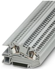
Borne de instalação, tensão nominal: 400 V, corrente nominal: 32 A, Conexão à mola, 1. nível, Bitola: 4 mm<sup>2</sup>, perfil de conexão: 0,08 mm<sup>2</sup> - 6 mm<sup>2</sup>, tipo de montagem: NS 35/7,5, NS 35/15, cor: cinza
