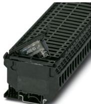
Borne fusível, tipo de fusível: Vidro/cerâmica/..., tipo de fusível: G / 5 x 20 / 5 x 25 / 5 x 30, tensão nominal: 24 V, corrente nominal: 6,3 A, número de polos: 1, tipo de conexão: Conexão a parafuso, Bitola: 1 mm<sup>2</sup>, bitola: 0,2 mm<sup>2</sup>- 4 mm<sup>2</sup>, tipo de montagem: NS 35/7,5, NS 35/15, NS 32, cor: preto
