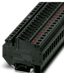
Borne fusível, tipo de fusível: Plano, tipo de fusível: C, tensão nominal: 24 V, corrente nominal: 30 A, número de polos: 1, tipo de conexão: Conexão a parafuso, 1. nível, Bitola: 4 mm<sup>2</sup>, bitola: 0,2 mm<sup>2</sup>- 10 mm<sup>2</sup>, tipo de montagem: NS 35/7,5, NS 35/15, NS 32, cor: preto
