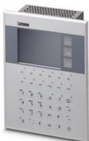
Painel de teclas, 320 x 240 pixel (QVGA), 5 graduações de cinza, Arm9™, 200 MHz, 2x USB Host 2.0, 1x Ethernet (10/100 MBit/s), RJ45, Windows® CE 5.0, Visu+ / AX OPC Server, sem sistema de bus.
