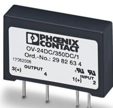
Relés de estado sólido, para amplificação de sinal e isolamento galvânica dos circuitos de comando e de carga, plugável em bases de encaixe soldáveis SIM-AMS ou com conexão de circuito impresso para montagem direta sobre placa de condutores, entrada 4,25-32 V DC, saída: 1-350 V DC / 1 A
