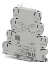
INTERFACE PLC, relé de estado sólido integrado, com conexão por rosqueamento, para montagem sobre trilho de fixação NS 35/7,5, entrada: 220 V DC, saída: 12-300 V DC/1 A
