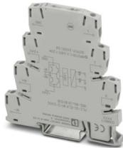
PLC-INTERFACE como relé eletrônico de inversão de carga, composta por terminal básico PLC-BSC.../21 com conexão a parafuso e circuito integrado, para o controle de motores DC com indicador luminoso e circuito de proteção, saída: 10 ... 30 V DC/2 A
