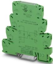
PLC-INTERFACE para aplicações ferroviárias, composta por terminal básico com conexão de mola de tração e relé de estado sólido miniatura integrado, faixa:  $0,7 \times U_N$  a  $1,25 \times U_N$ , faixa de temperatura:  $-25 \text{ °C}$  a  $+70 \text{ °C}$ , 1 contato normalmente aberto, entrada: 110 V DC, saída: 3-33 V DC/3 A
