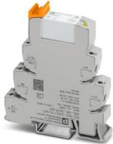
PLC-INTERFACE para correntes de conexão altas, composta por terminal básico PLC-BSC.../1 IC/ACT com conexão a parafuso e relé miniatura plugável, para montagem em trilho de fixação NS 35/7,5, corrente de conexão máx. até 130 A, 1 contato normalmente aberto, tensão de entrada 24 V DC
