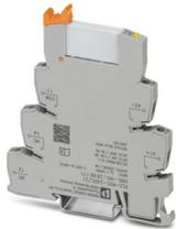
PLC-INTERFACE, composto de borne básico CLP-BSC.../21 com conexão a parafuso e relé miniatura plugável com contato de potência para montagem sobre trilho de fixação NS 35/7,5, 1 inversor, tensão de entrada 24 V DC
