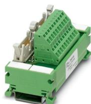
Módulo de transferência VARIOFACE para SIMATIC® S7-300, para máx. 16 canais com inscrição específica SIMATIC® (1 - 20), conexão à mola, largura de módulo: 98 mm
