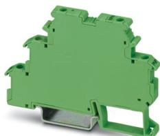
**Módulo do inversor** O módulo do inversor inverte os sinais de saídas de transistor NPN com ligação referenciada ao terra em saídas PNP com ligação positiva, bem como sinais de sinais com ligação PNP em NPN.
