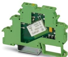
Borne de relé para sensor, com relé miniatura soldado fixamente, contato (AgNi+Au): potências pequenas a médias, 1 elemento de contato, tensão de entrada 24 V AC/DC, para montagem sobre NS 35/7.5, largura de bornes 6,2 mm
