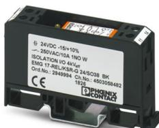
Módulo de relé para altas correntes de comutação, com relé soldado, contatos (AgSnO<sup>2</sup> + avanço de tungstênio): potências médias a grandes, 1 elemento de contato, tensão de entrada 24 V DC, máx. corrente de comutação 80 A
