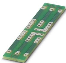
Placa de circuito impresso, para montagem de componentes eletrônicos
