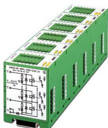
Módulo de relé, multicanal, com 4 relés de comutação pequenos soldados fixamente para tensão contínua com indicador luminoso e 1 contato reversível cada, contato para potências médias a altas, tensão de entrada 24 V DC
