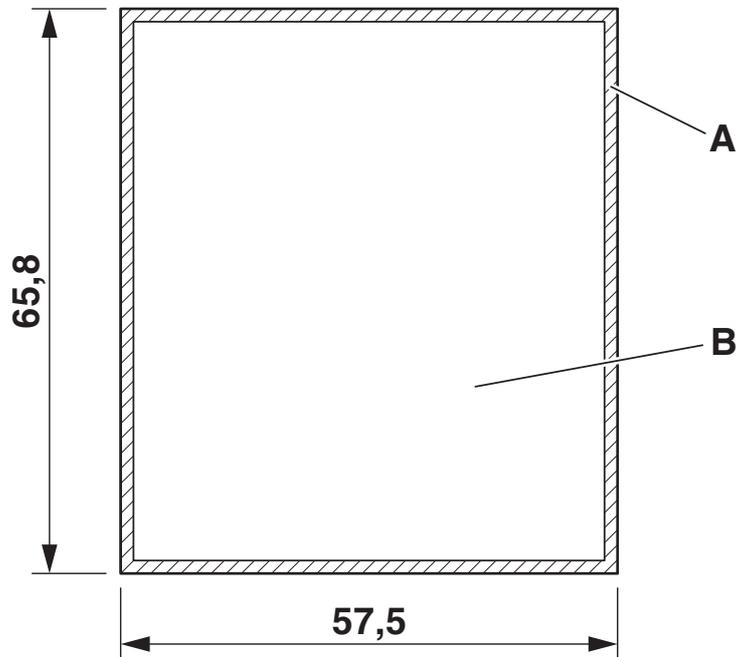
Placa de circuito impresso 3 e 4 para EMUG 25 e EMUG 45 paralela à parede lateral da parede da caixa
