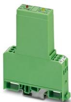
Relé de estado sólido de potência, com indicador luminoso e ligação de proteção no circuito de entrada e saída, entrada: TTL 5 V DC, saída: resistente a curto-circuito, 24 V DC/máx. 2 A
