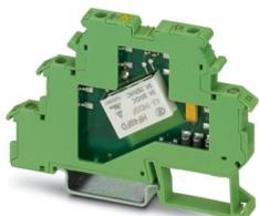
Borne de relé, com relé miniatura soldado fixamente, contato (AgNi+Au): potências pequenas a médias, 1 elemento de contato, tensão de entrada 5 V AC/DC, para montagem sobre NS 35/7.5, largura de bornes 6,2 mm, montagem invertida
