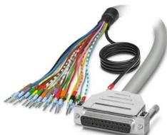
Cabo circular, montado blindado; conexão 1: Condutores individuais (25-polos) (Os condutores estão identificados e equipados com terminais tubulares. A malha de blindagem sai para uma extremidade de cabo separada.); conexão 2: Conector de soquetes D-SUB (1x 25-polos); comprimento de cabo: 0,5 m
