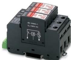
Proteção contra surtos p/sistemas tensão contínua 2 pólos isolados e aterrados 1000 V DC, p/ fixação sobre trilho, base 3 pólos (L+, L-, terra) c/contato sinalização remoto, três varistores plugáveis c/ monit. temp., indicação estado em cada plugue.
