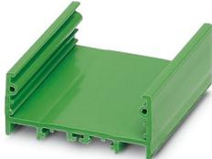
Caixa de perfil de extrusão, Perfil básico, largura de perfil (interna): 41,85 mm, largura de perfil (externa): 44,8 mm, comprimento: 1000 mm, altura: 44,8 mm, profundidade: 18,95 mm, Nota: comprimento de perfil necessário = comprimento da placa de circuito impresso - 3 mm
