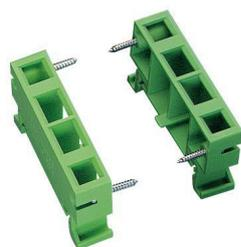
Elemento lateral com base, identificável com SS-ZB, montagem no sentido longitudinal em relação ao trilho de fixação NS 35/7,5. Altura: 36 mm, largura: 10 mm, comprimento: 45 mm.
